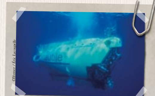
Le Nautilus, sous-marin habité de l'Ifremer, peut observer et expérimenter jusqu'à 6 000 m de profondeur.
